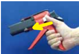
① P G (充填機) の側面レバーを図の様に押します。
