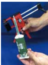
①セット完了した P G (充填機) と P M (主剤+硬化剤) を準備する。
