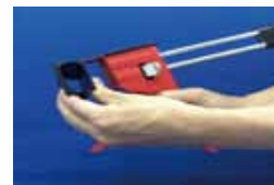
③ P M (主剤+硬化剤) 収納ソケットを図のように回転させます。これで P G (充填機) の準備は終了です。
